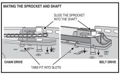
BE SURE THE FLAT ON THE SPROCKET LINES UP WITH THE FLAT ON THE DRIVE SHAF
