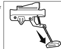
Le chariot se réenclenche lors de la prochaine ouverture ou fermeture de la porte, soit manuellement ou à l'aide de la commande de la porte ou de la télécommande.
